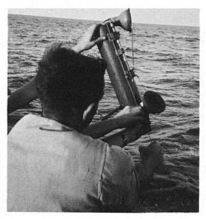
PLACING A PLASTIC BIOLOGICAL SAMPLER ON THE WIRE
